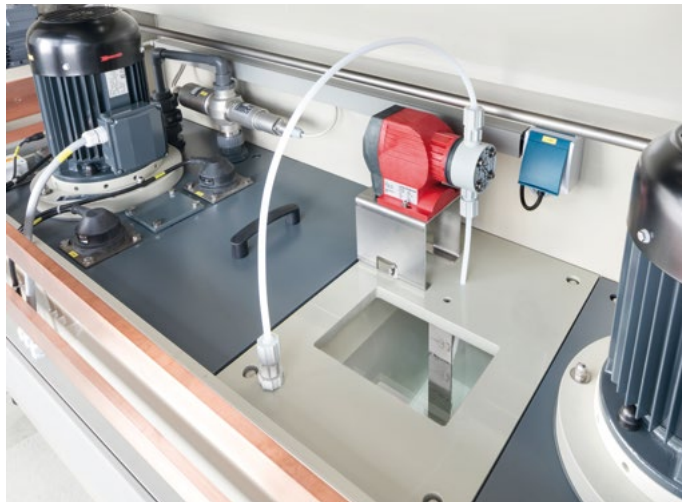
Electrolyte circulation, copper sulfate measurement, hardening additive dosing Elektrolytumwälzung, Kupfersulfatmessung, Härtezusatzdosierung
