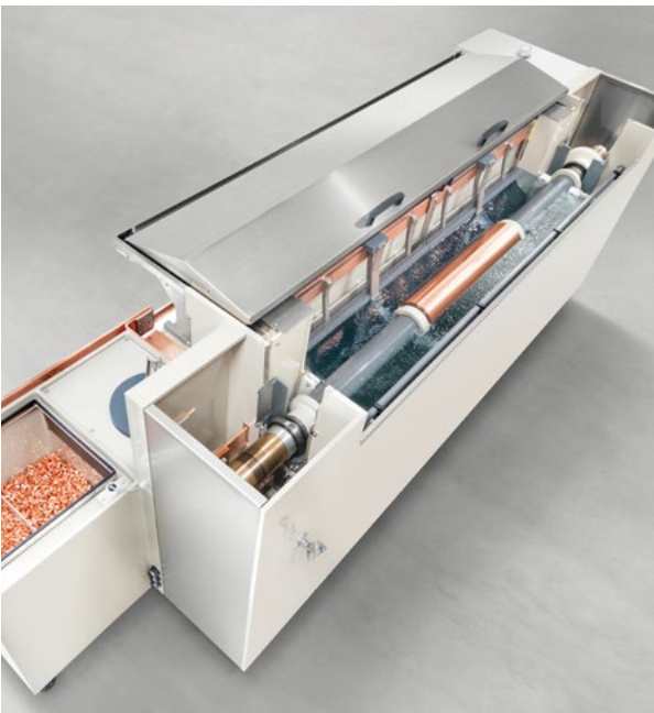
Copper tank with integrated CuMax GII Kupferbad mit integriertem CuMax GII
