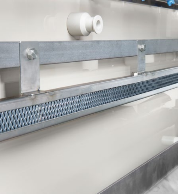
Insoluble anode Unlösliche Anode
