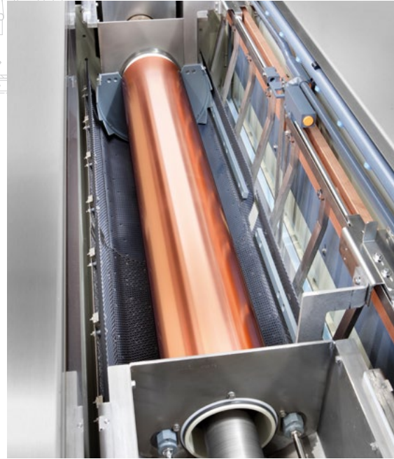
Anode basket with cylinder in working position Anodenkorb mit Zylinder in Arbeitsposition
